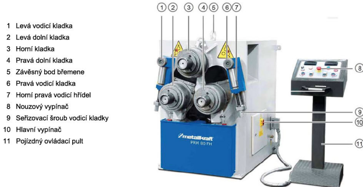
Obr. 5: Ovládací prvky zakružovačky PRM 80 FH
